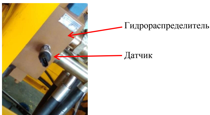
Рисунок 30 – Датчик давления в контуре навесного оборудования
