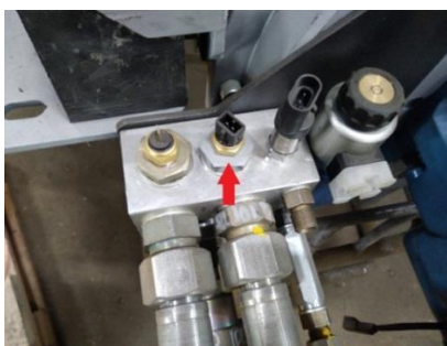
Рисунок 37 – Датчик температуры гидравлического масла
