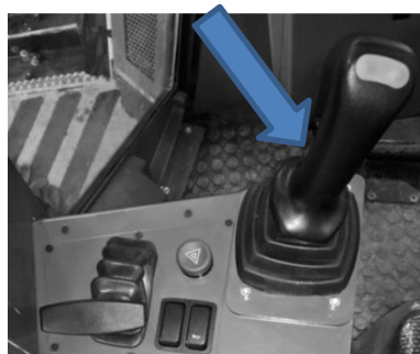
Рисунок 5 – Джойстик управления движения в нейтральном положении
