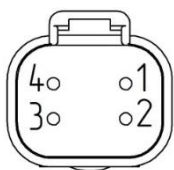
Рисунок 14 – Распиновка разъема датчика скорости
