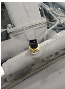
Рисунок 39 – Датчик температуры охлаждающей жидкости на двигателе ЯМЗ-238
