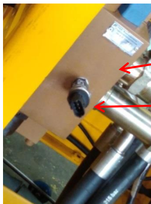
Рисунок 36 – Датчик давления в контуре навесного оборудования
