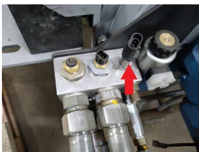
Рисунок 29 – Датчик давления в тормозном контуре
