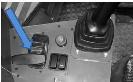
Рисунок 8 – Джойстик управления оборотами ДВС
